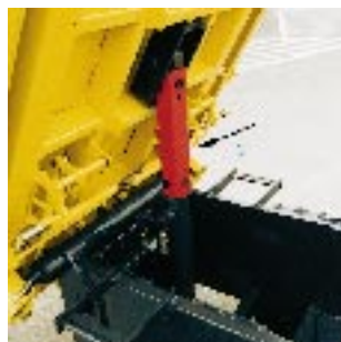
Abb. 69: Abstützung der Mulde
