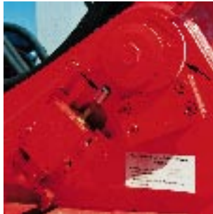
Abb. 62: Überlastwarnanlage am Gerät
