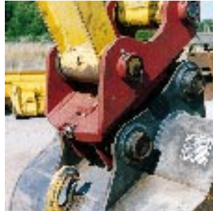
Abb. 45: Schnellwechseleinrichtung für Bagger
