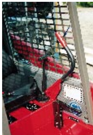
Abb. 22: Sicherung der Stellteile bei Kompaktladern
