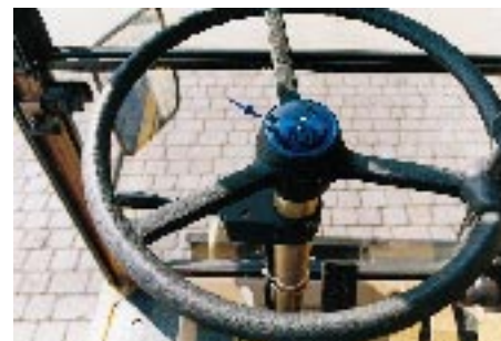
Abb. 58: Optische Oberwaganzeige im Lenkrad
